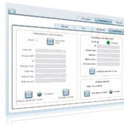
**Connexions à l'Internet.** Certaines fonctionnalités de UNA requièrent l'accès au réseau Internet (assistance, mises à jour, commandes). UNA peut se connecter à l'Internet par Wi-Fi, câble Ethernet ou à l'aide d'une clé internet USB avec la carte du fournisseur d'accès, quel qu'il soit.
