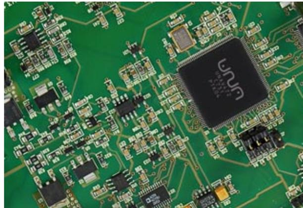
**Composants miniature.** Nous avons construit pour UNA des cartes électroniques en SMT. Cette technologie, employée pour construire les téléphones portables, utilise des composants jusqu'à 50 fois plus petits que les composants traditionnels. Grâce à cela, nous avons pu exploiter tous les espaces vides et placer plus de 5 000 composants électroniques dans UNA.
